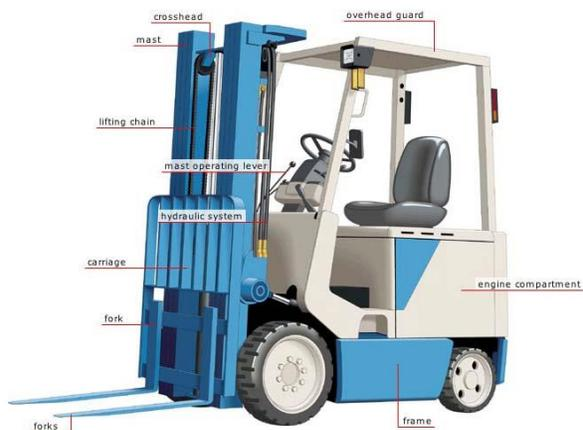
Рисунок 1 – Изображение электропогрузчика с описанием компонентов
