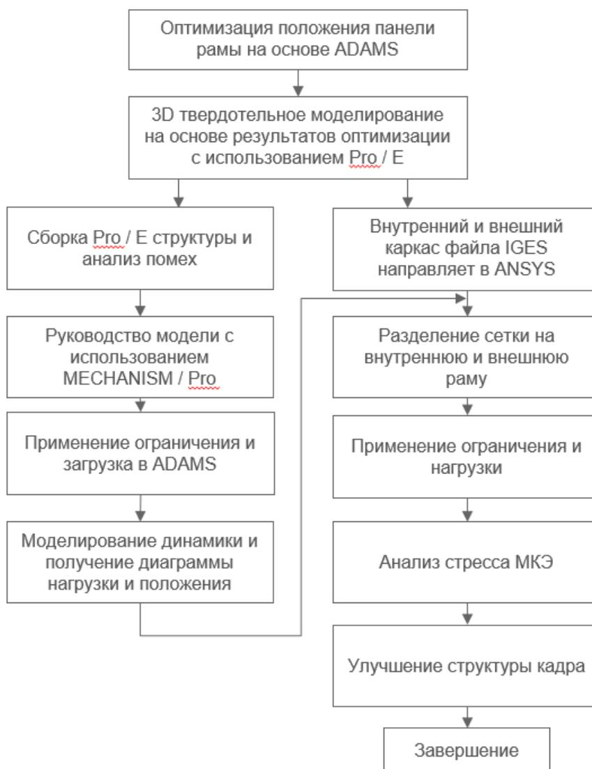
Рисунок 8 – Компьютерное моделирование и анализ рамы погрузчика
